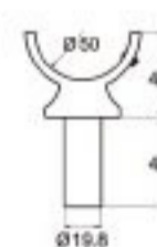
ΣΤΗΡΙΓΜΑ ΚΟΥΠΑΣΤΗΣ Φ50 ΣΕ ΚΟΛΩΝΑ Φ40 HALF PILLAR CONNECTION 40x50
