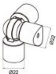
ΓΩΝΙΑ ΡΥΘΜΙΖΟΜΕΝΗ 3 ΥΠΟΔΟΧΩΝ Φ16 ADJUSTABLE Φ16 BEND
