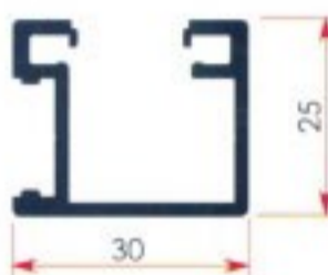
ΚΟΛΩΝΑ ΣΤΗΡΙΞΗΣ ΤΖΑΜΙΟΥ 30x25 mm GLASS STRUT 30x25 mm
